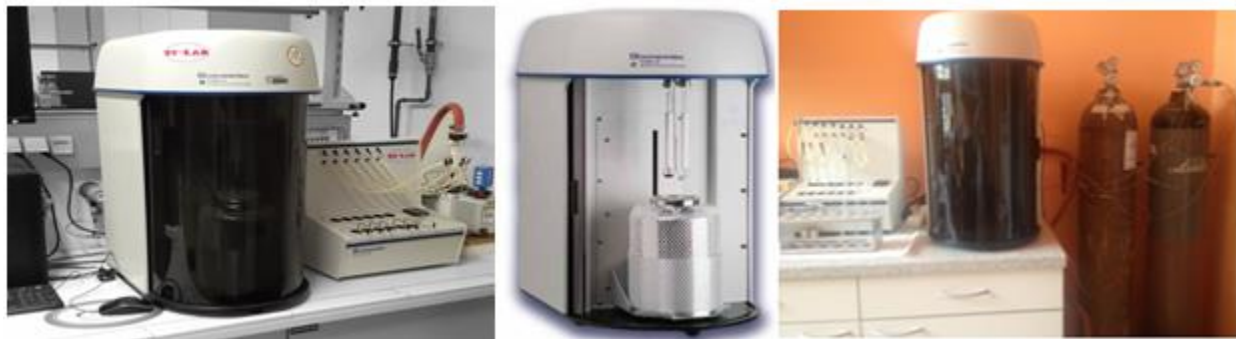
Figura 2.6. Porozimetri Micromeritics Tristar II 3020.
