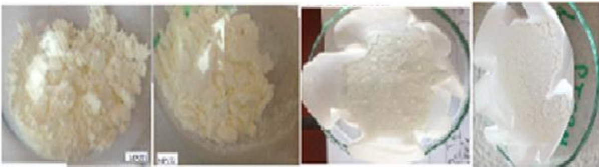
Figura 2.3. Mostrat poroze monolitike poliHIPE(DVB-VBC) me tris(2-aminoetil)aminë: M_3T_1 , M_3T_2 , M_3T_3 , M_3T_4 të përfituara gjatë punës laboratorike.
