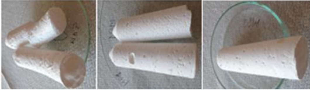
Figura 2.1. Mostrat poroze monolitike poliHIPE(DVB-VBC): M_1 , M_2 , M_3 të përfituara gjatë punës laboratorike.
