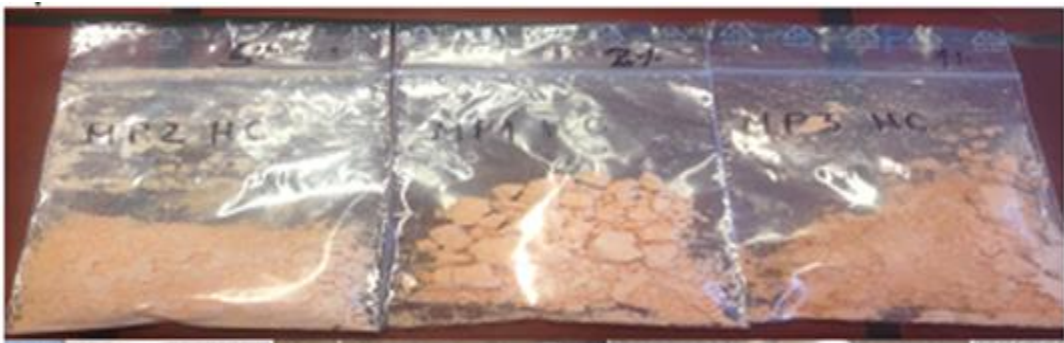
Figura 2.1. Mostrat poroze monolitike poliHIPE(DVB-VBC): M_1 , M_2 , M_3 të përfituara gjatë punës laboratorike.
