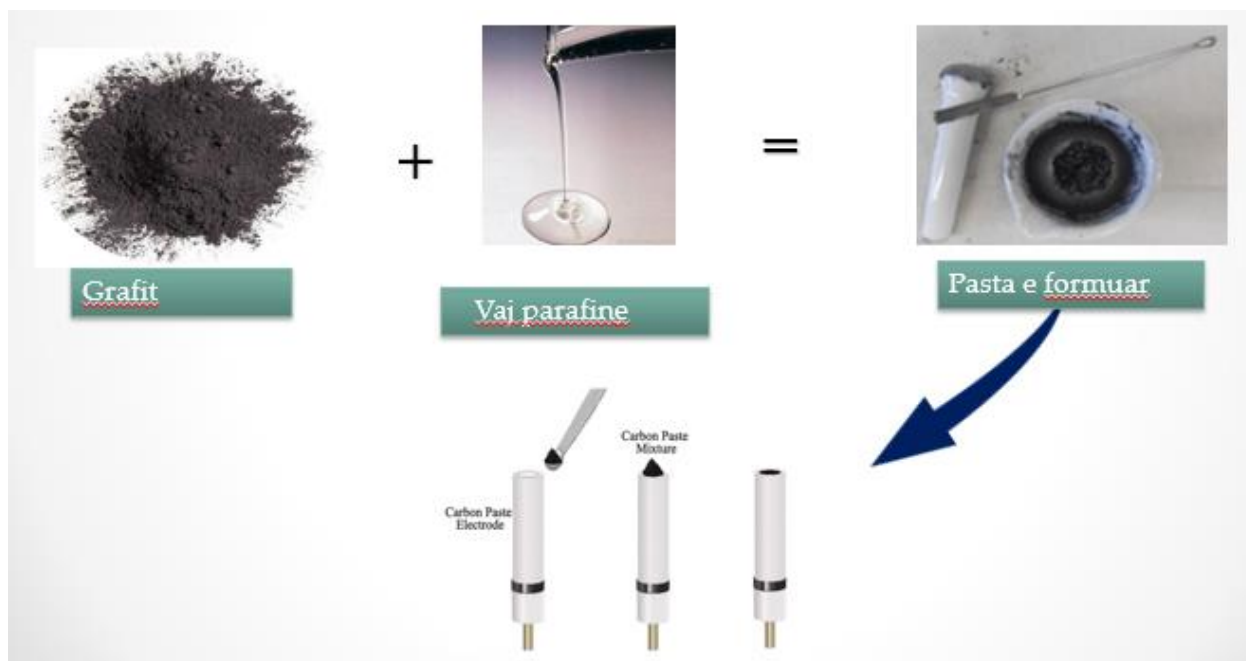
Figura 2.10. Procesi i përgatitjes së pastës së karbonit dhe vendosja e saj në piston
